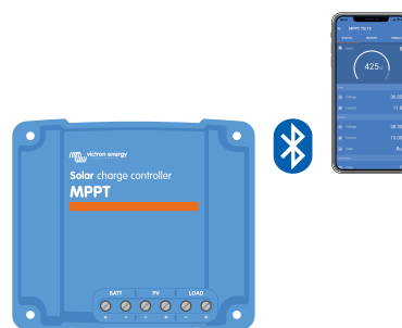
Verbindung zur VictronConnect App über integriertes Bluetooth
