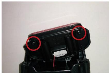
Danach entfernen Sie die beiden Schrauben mit denen das Rücklicht an der Abdeckung befestigt ist.
