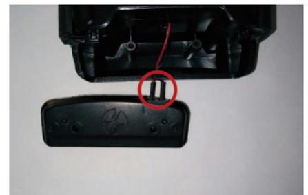
Zu guter Letzt, ziehen Sie die Verbindungskabel von der Rückleuchte. Bitte ziehen Sie direkt an den Kontakt. Bitte ziehen Sie nicht an den Kabeln!
