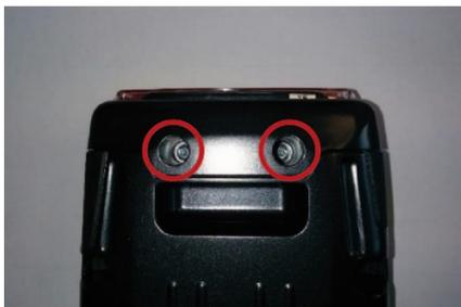
Entfernen Sie die Abdeckung des Rücklichtes, indem Sie die beiden Schrauben entfernen.
