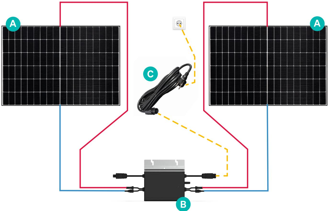
Hinweis: Diese Abbildung dient nur als Richtlinie und gibt die abgebildeten Produktkomponenten möglicherweise nicht exakt wieder. Stellen Sie bei dere Installation sicher, dass Plus- und Minusleitungen korrekt miteinander verbunden werden.
